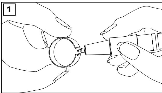
1) Setzen Sie die kreisrunde Metallpinzette mit der Öffnung an die Mine des Kaweco EMR Einsatzes an.
