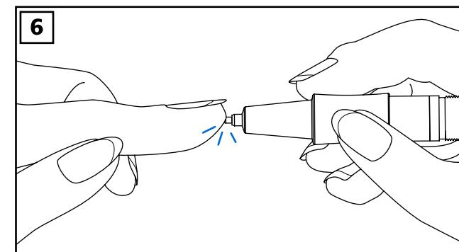
6) Drücken Sie die Mine bis zum Anschlag fest in den Einsatz. Der Kaweco EMR Einsatz ist nun wieder einsatzbereit.
